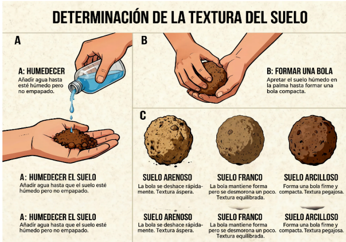
Figura 12. Prueba del puño para determinar la textura del suelo.
